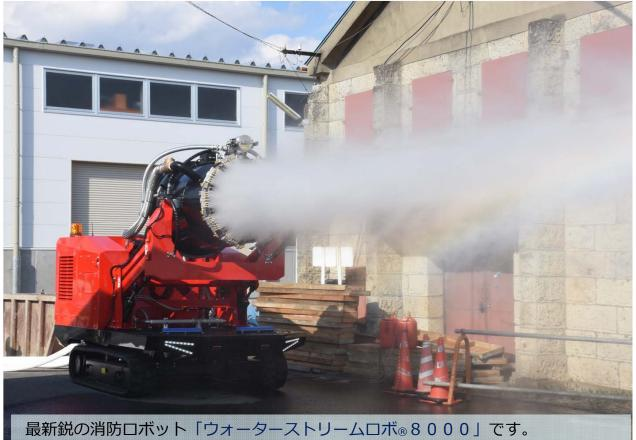
最大約8000L/min放水ノズルと風速40m/secの大型ブロアー、そして 異次元のミスト放水ノズルを兼ね備えた1台3役の消防ロボットです。
